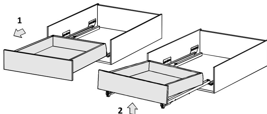
**Снятие ящика на скрытых направляющих**
