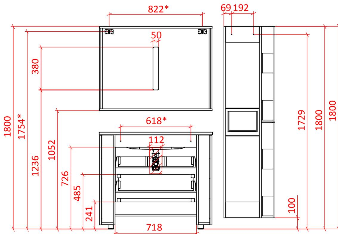
Рекомендуемая зона вывода коммуникаций заштрихована на чертеже. Расстояния от стены до задней стенки ящиков 37мм.
